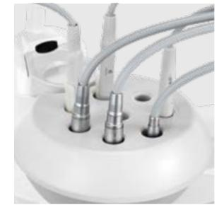
**BIOSTER et FLUSHING.** BIOSTER est le système automatique de désinfection intensive des circuits internes des sprays des instruments au moyen d'un liquide antiseptique (Peroxy Ag<sup>+</sup>). Le logiciel contrôle chaque phase du cycle et l'opérateur peut personnaliser les paramètres. FLUSHING est un rinçage rapide des conduites des sprays. Il élimine le liquide stagnant dans les conduits et est recommandé tous les matins à l'ouverture du cabinet.
