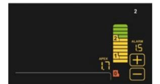
**Localisateur d'apex.** Lors de l'instrumentation du canal radiculaire, la distance par rapport à l'apex est affichée sur l'écran LCD. La distance par rapport à l'apex est vérifiée par le logiciel ENDO. Lorsque l'apex est atteint, la rotation du micromoteur est interrompue par la fonction Apex-Stop.
