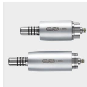
**Micromoteurs.** Deux versions : i-MMr (3,3 Ncm) avec LED ; i-MMs (5,3 Ncm) avec éclairage LED, prédisposition pour des traitements endodontiques. De 100 à 40 000 tours/min.
