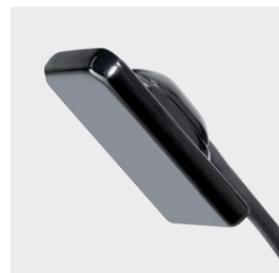
C-U2 Aux limites de la technologie de l'imagerie, C-U2, avec pièce à main métallique, optique en verre et diffuseur LED, intègre un capteur HD 16:9 pouvant prendre des images cliniques à haute définition. Aucune mise au point manuelle grâce à la grande profondeur : de 5 mm mini à 70 mm maxi.
