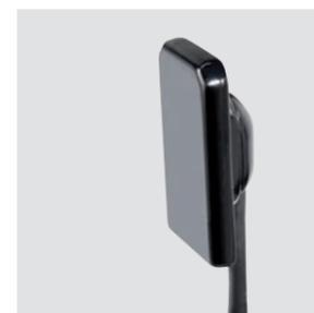
Capteur radiographique intégré à la tablette praticien et entièrement géré par le logiciel multimédia de l'unité de soins. Diagnostic de précision à portée de la main et grand confort grâce à sa forme arrondie qui s'adapte facilement à l'anatomie de la cavité buccale. Si le capteur est installé, la position de la console sera fixe.
